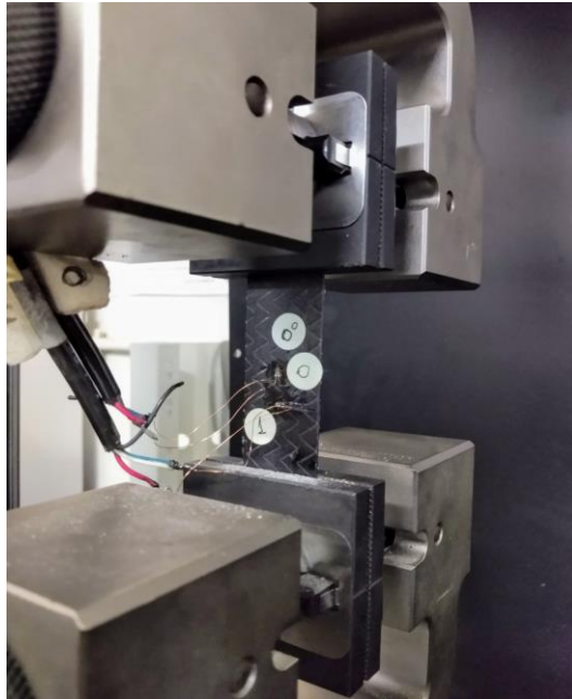
Figura 22 - Teste de tração do corpo de prova com fibras a 0^\circ em relação a carga.
