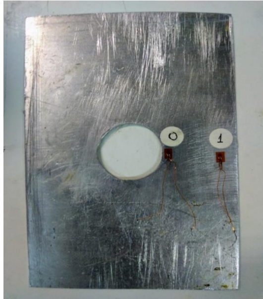
Figura 27 - Placa de material isotrópico com um furo circular no centro.
